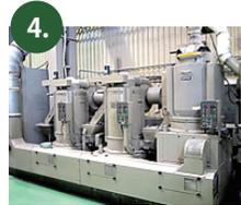
4. 精米機は連座式の大型精米機を使い、少しずつ削りながら温度上昇を防ぎおいしく仕上げます。
