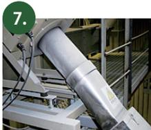
7. 金属検出器では電磁波の中を通過させることにより非鉄金属まで検出し排除します。
