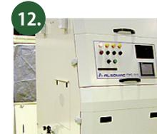
12. 袋詰前の最終チェックをスーパーエッカーを用いて行います。特殊 CCD カメラと特殊センサーの組み合わせで白米の中に混入するあらゆる異物を検出・除去します。
