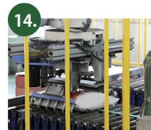
14. 袋詰めした商品を口ボットがパレットに積み上げていきます。
