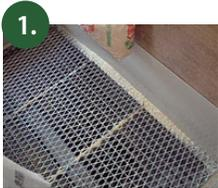
1. 異物混入を防ぐため、お米の投入口のふちを20センチほど高くしてあります。コンタミ防止のため、投入前は残留米の確認を行っています。
